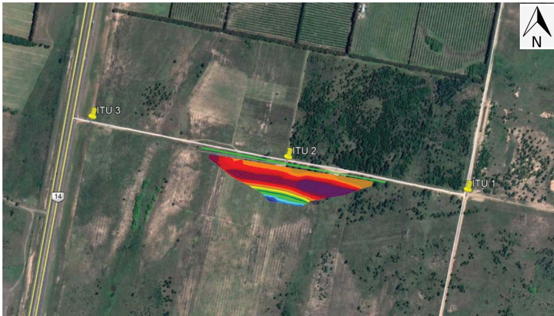
Figura 9. Imagen de resistividad ERT 001 mediante arreglo Schlumberger
